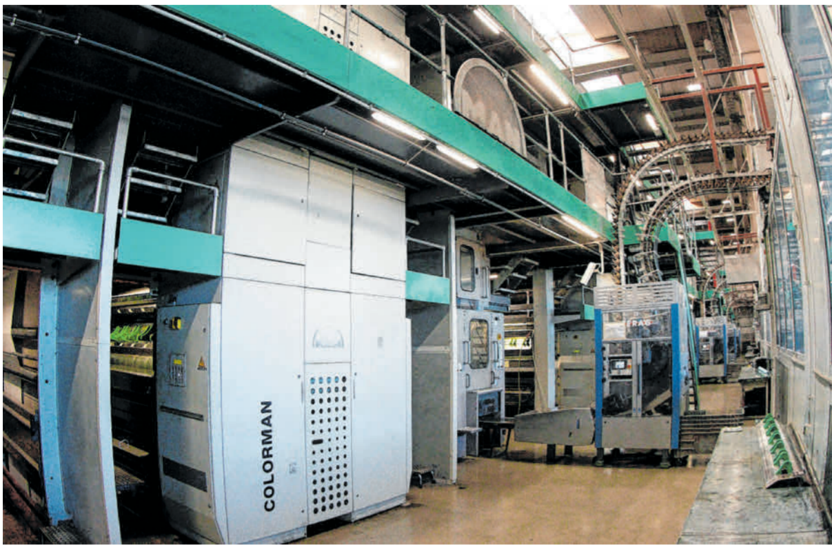
1.300 Tonnen bringt die Rotationsmaschine auf die Waage. Das Schwergewicht ist 64 Meter lang, 13 Meter hoch und neun Meter breit. Fotos: Bernhard Weizenegger
